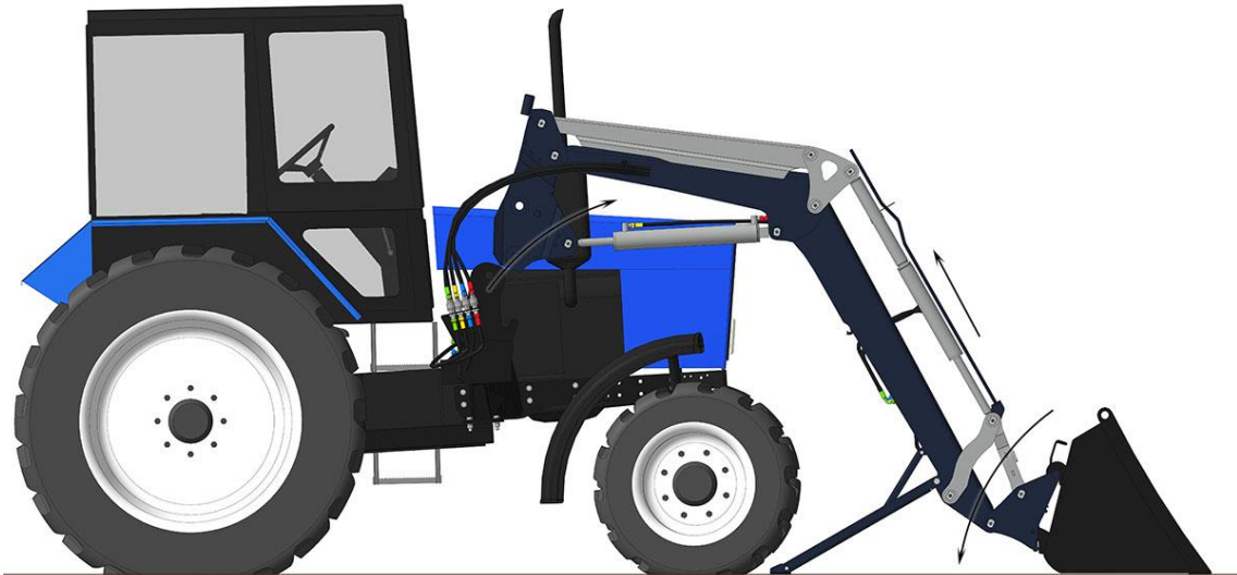
Рис. 2.6 – Демонтаж погрузчика Универсал
